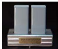
本物のウエスタンのトランスを分解し取り出したコア部分に新たに銅線を巻いて作った「再生品」のトランスを使用したAIRBOWオリジナル・ラインマッキングトランス。入力インピーダンス、昇圧比の異なる3種類のモデルがあります。入力/出力インピーダンス LINE : 600Ω (CD用) / 15KΩ HIGH : 3~10Ω / 5KΩ LOW : 10~100Ω / 50KΩ
